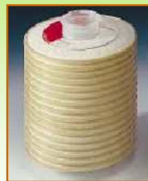
Elemento filtrante a cartuccia, con eccezionali capacità di trattenimento delle particelle inquinanti, 2 micron assoluti con rapporto \beta \geq 1000
